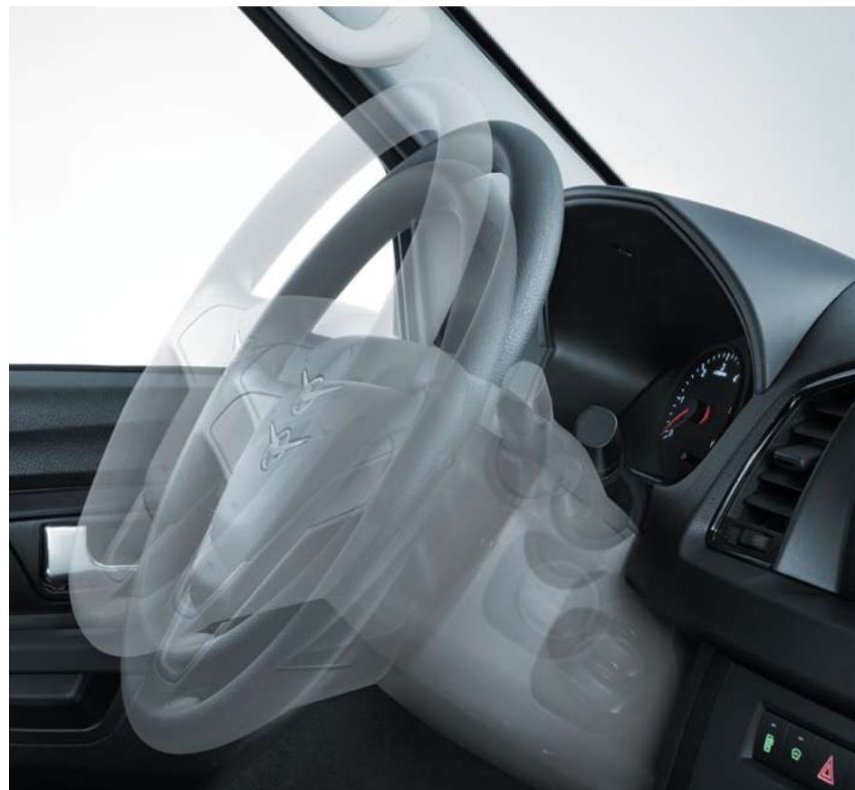
Регулировка руля по высоте и по вылету
