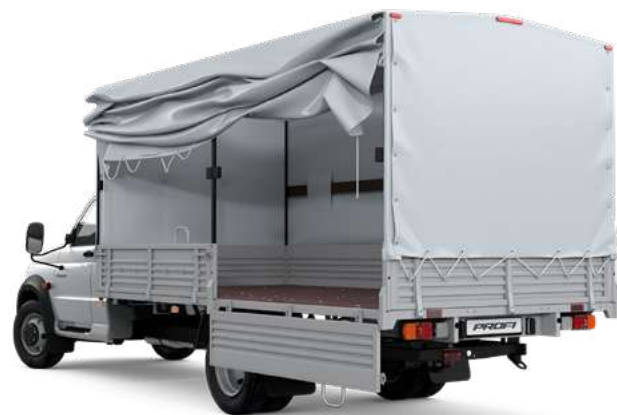
Платформа с возможностью отдельного открывания бортов
