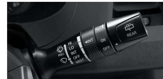
Правый подрулевой переключатель с регулировкой паузы стеклоочистителя
