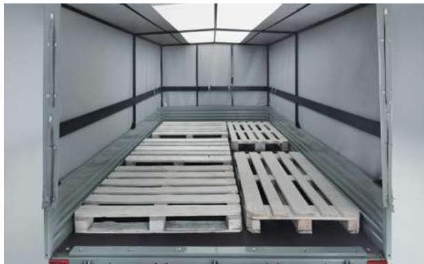
Светопроницаемая крыша. Прочный проклеенный тент
