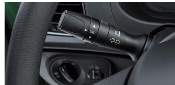
Современные подрулевые переключатели и блок управления светом
